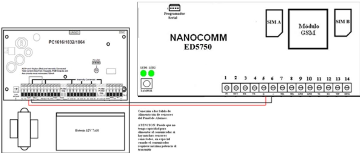
**Caso 3. Conexión a la Batería del Panel de Alarmas (Fuera de Normas).**
